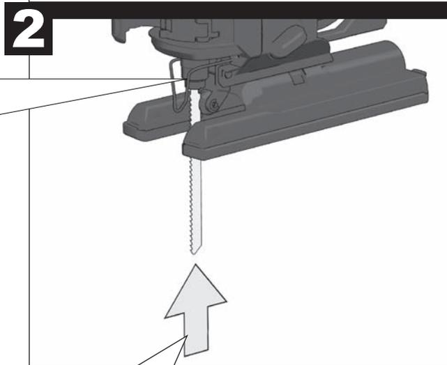
Вставить пильное полотно в захват Fixtec до упора.
