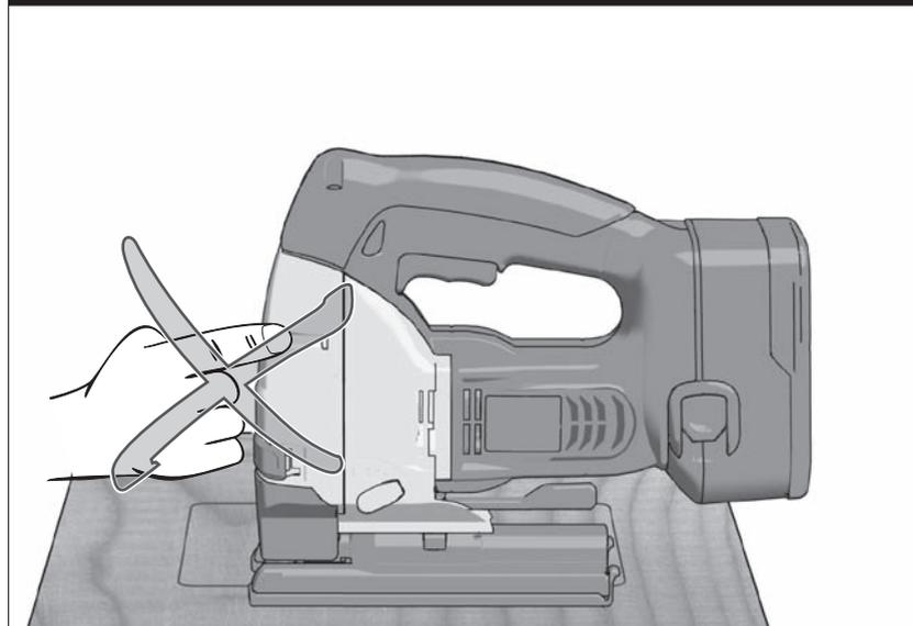
Если Вы выполняете работы, при которых режущий инструмент может зацепить скрытую электропроводку кабель, инструмент следует держать за специально предназначенные для этого изолированные поверхности. Контакт режущего инструмента с токоведущим проводом может ставить под напряжение металлические части прибора, а также приводить к удару электрическим током.
