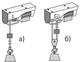
a) В режиме без полиспаста используется основной крюк 7, что обеспечивает максимальные высоту и скорость подъема/опускания.
